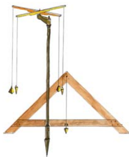
Les outils de l'arpenteur romain : groma et niveau
